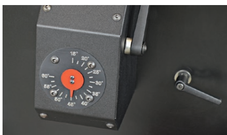
Réglage précis de l'angle de chanfrein
