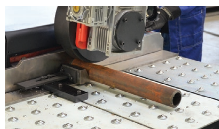
Possibilité de chanfreiner des tubes (extérieur)
