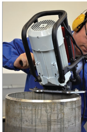
Fasen von Rohren
